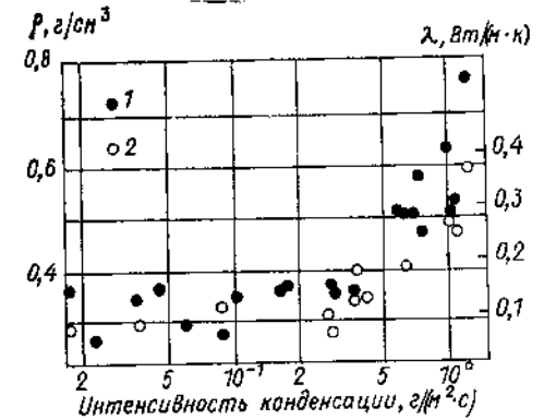
Рис. 67. Зависимость плотности конденсата \text{N}_2 и его теплопроводности от интенсивности конденсации 1 — плотность; 2 — теплопроводность
